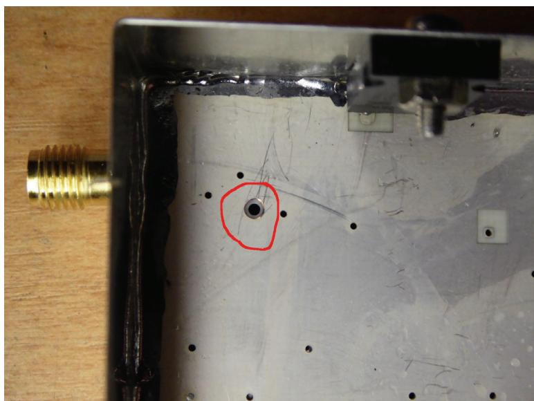
Un trou métallisé doit être modifié afin de permettre l'injection de l'oscillateur local (voir photo)
