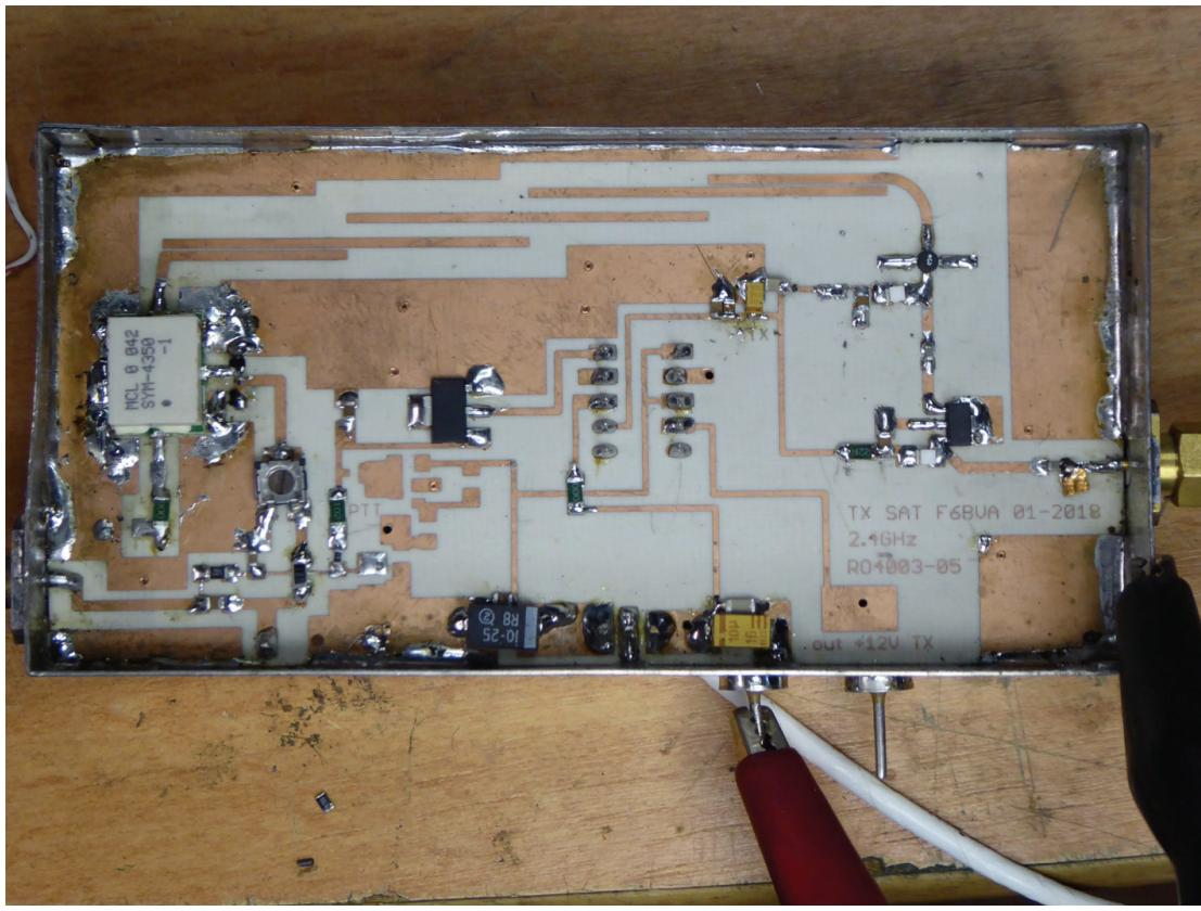
Conçu pour la voie montante du satellite Es'hail 2, et avec un cahier des charges assez simple.
