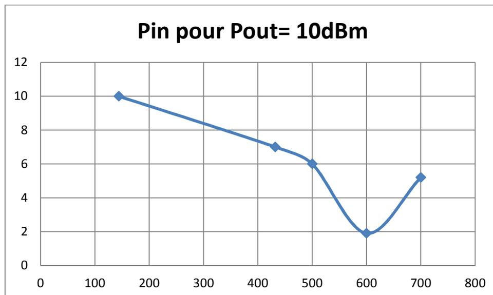
On constate que la plage optimale de fréquence se situe vers 600MHz. A 432MHz le fonctionnement est encore correct, à 144MHz ça devient limite, mais ça marche.
