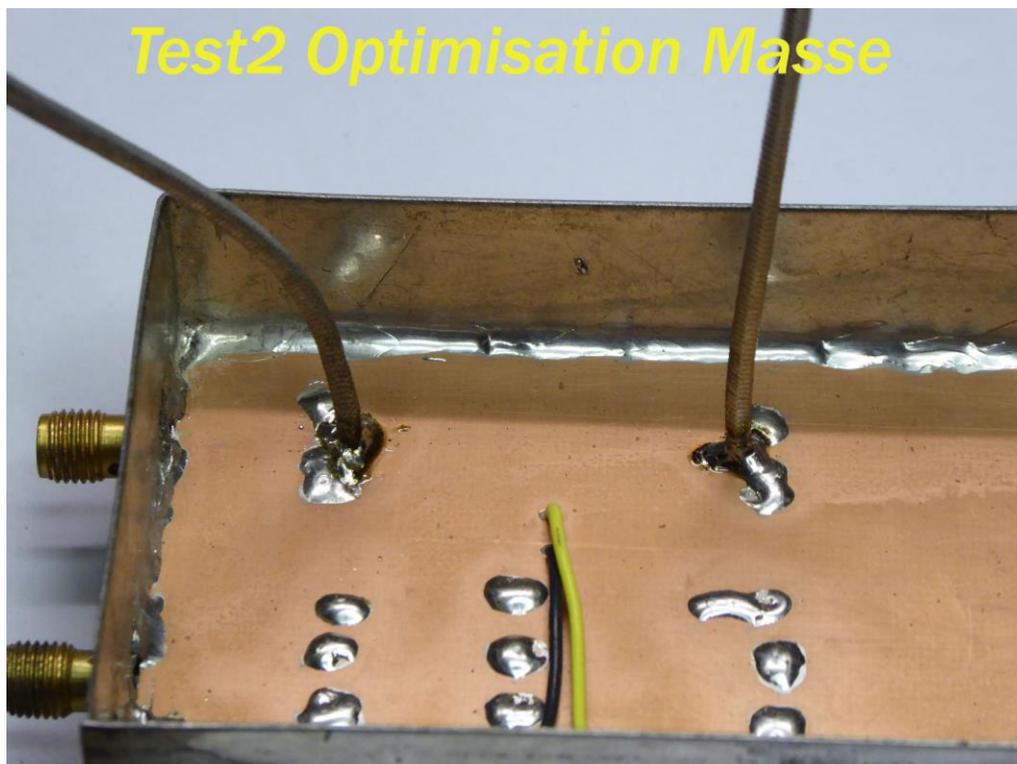
Passage à l'analyseur de réseau : pertes d'insertion mesurées sur le même filtre 4dB. Adaptation autour de  $-20$  dB.
